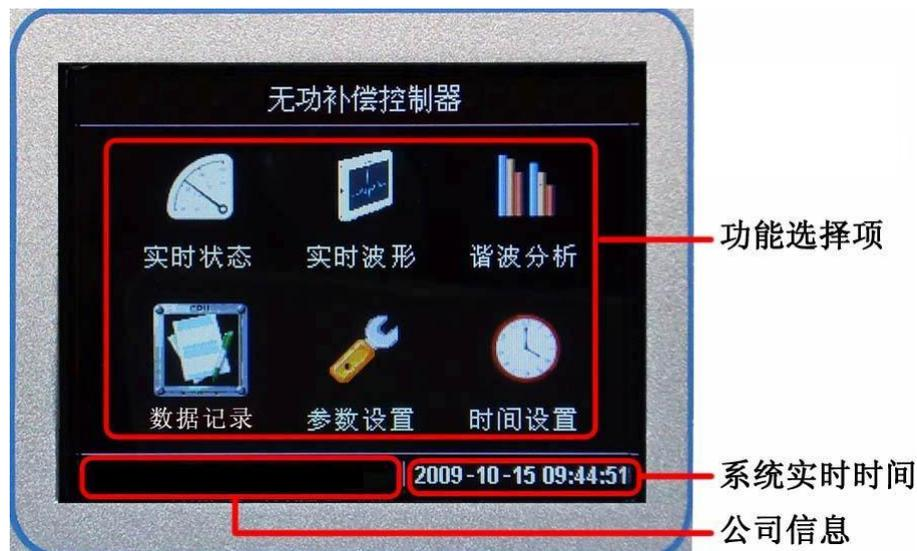
各个显示栏含义如上图右边说明，顶端为本控制器型号，中间为功能选择项，左下栏滚动显示公司信息，右下栏显示系统时间。
